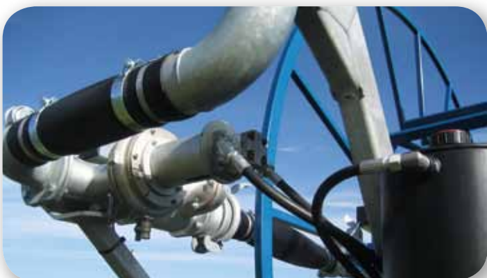
Vandturbin med hydraulikpumpe / Turbine à eau avec pompe hydraulique
