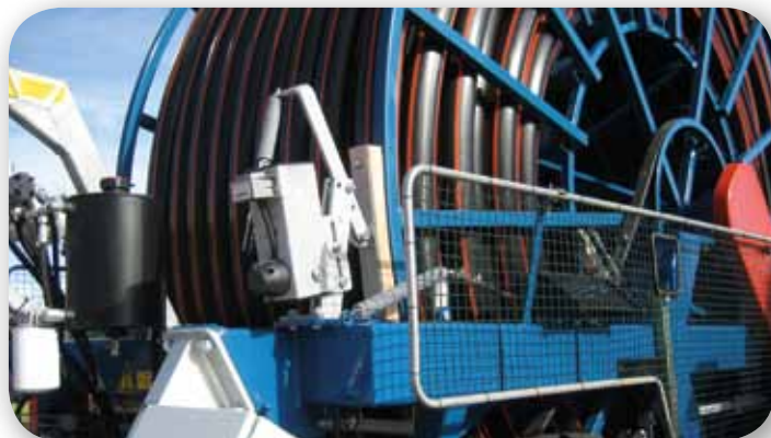
Elektrisk bremse med træklods / Frein électrique avec bloc en bois
