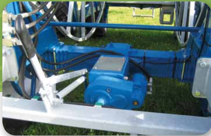
Industrielt bagtøj med til- og frakoblingsanordning / Pont arrière et arbre de transmission industriels avec dispositif de couplage et découplage
