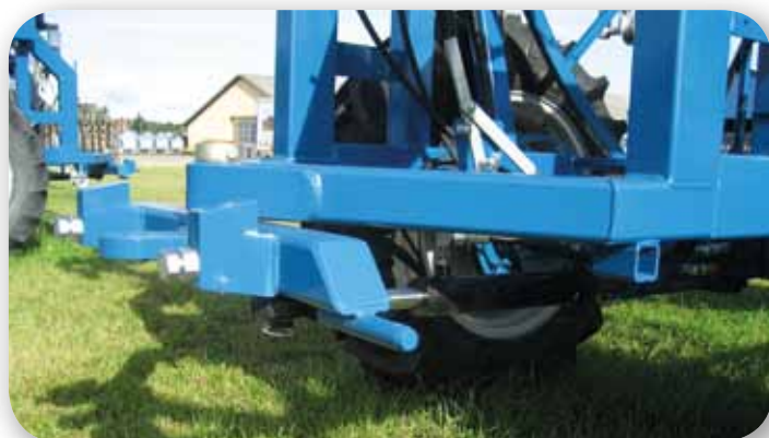
Bageste cylinder til tvangsstyring / Cylindre arrière pour la commande forcée
