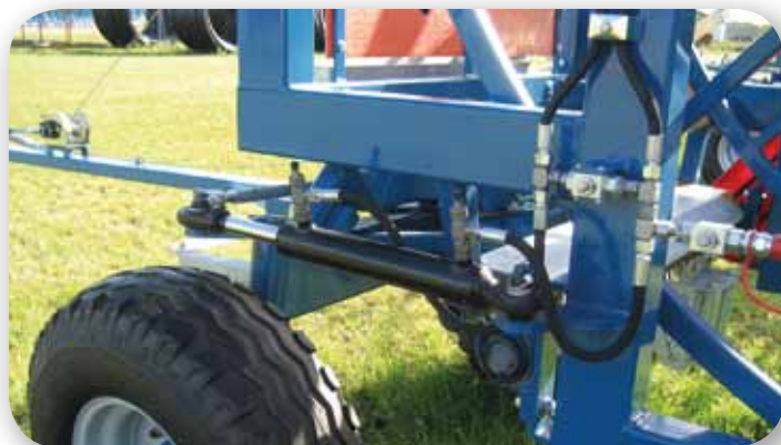
Forreste cylinder til tvangsstyring / Cylindre avant pour la commande forcée
